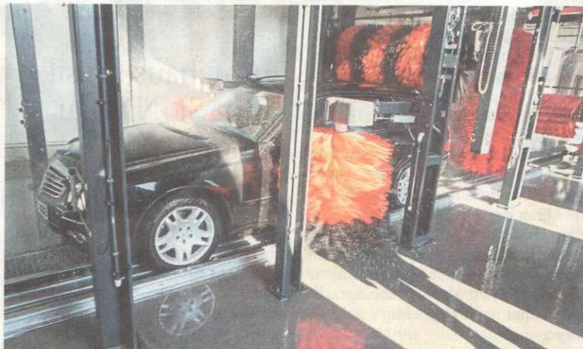
Die Waschstraße ermöglicht mit diversen Walzen auf verschiedenen Ebenen eine optimale Sauberkeit des Fahrzeugs.
